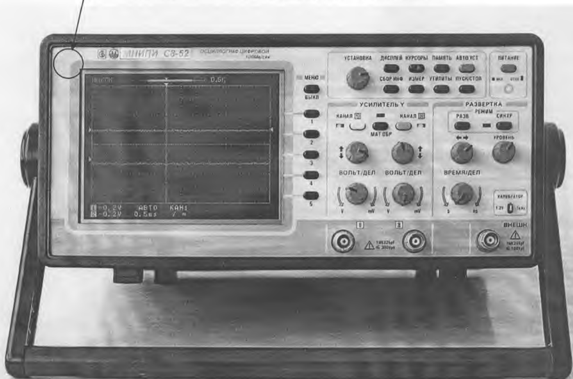
Рисунок А.1 – Передняя панель осциллографов с указанием места нанесения знака поверки
