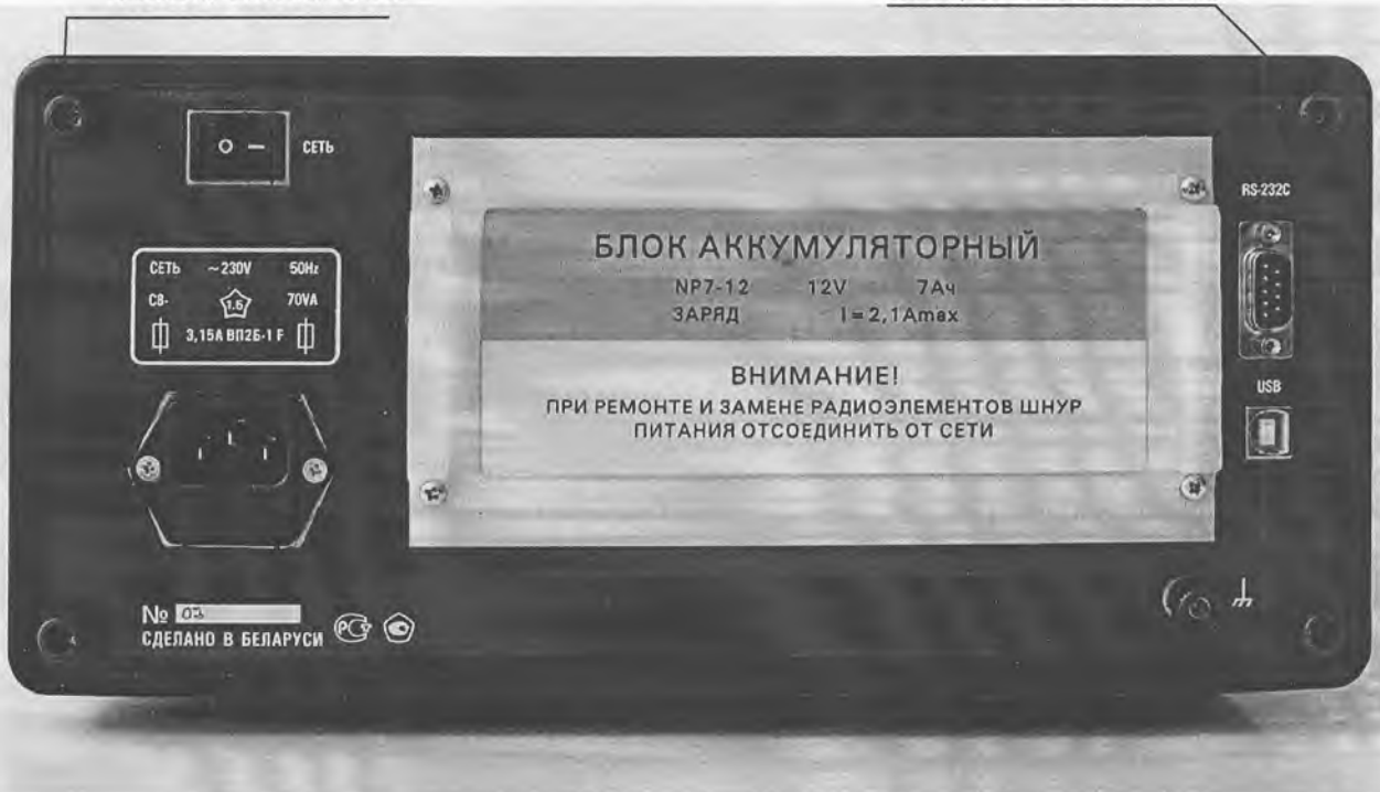
Рисунок А.2 – Задняя панель осциллографов с указанием мест нанесения поверительного клейма и оттиска клейма ОТК
