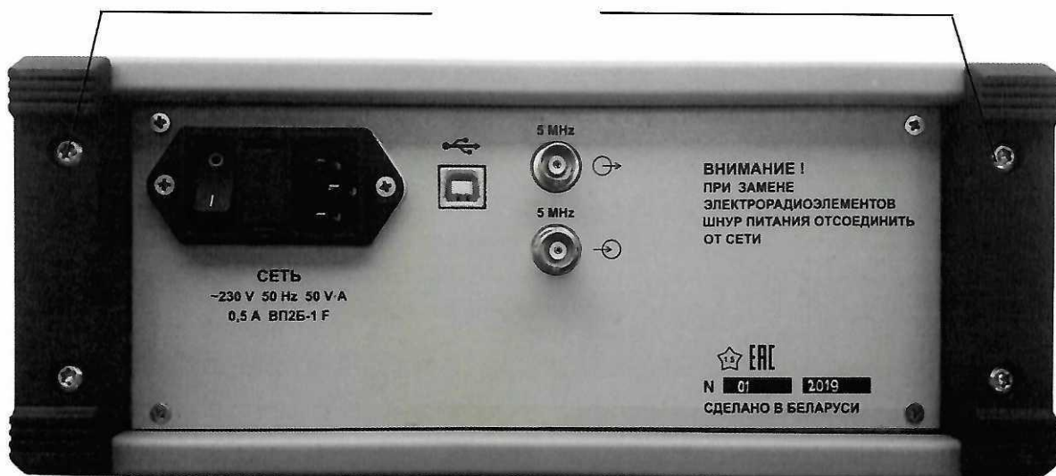
Рисунок 2.2 – Место пломбирования ОТК и нанесения оттиска знака поверки (вид частотомера сзади)
