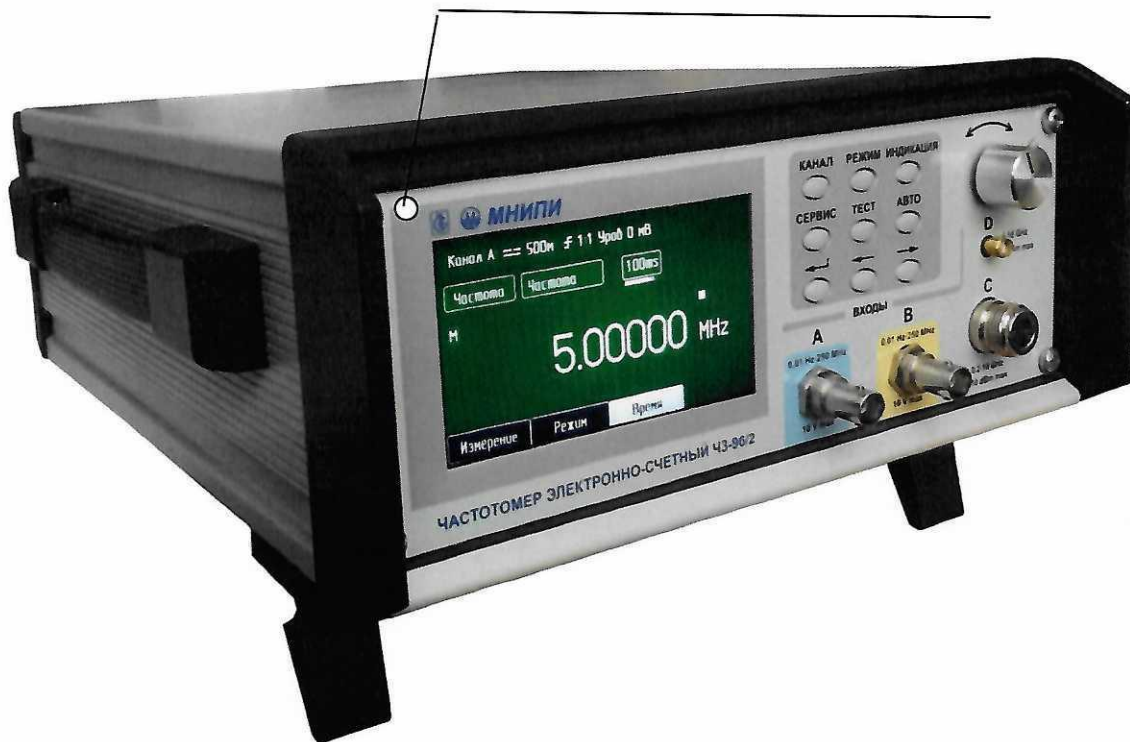
Рисунок 2.1 – Частотомер электронно-счетный ЧЗ-96/2. Место нанесения знака поверки (клейма-наклейки)
