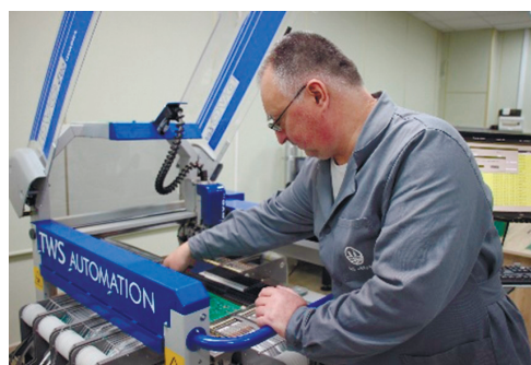
Рис. 2. Работа на линии поверхностного монтажа для установки SMD-компонентов
