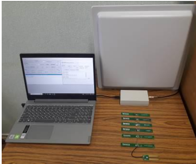
Рисунок 3 – Фото стационарной РЧС
