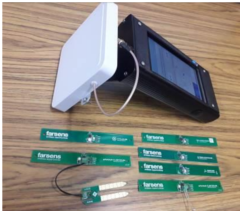
Рисунок 4 – Фото портативной РЧС
