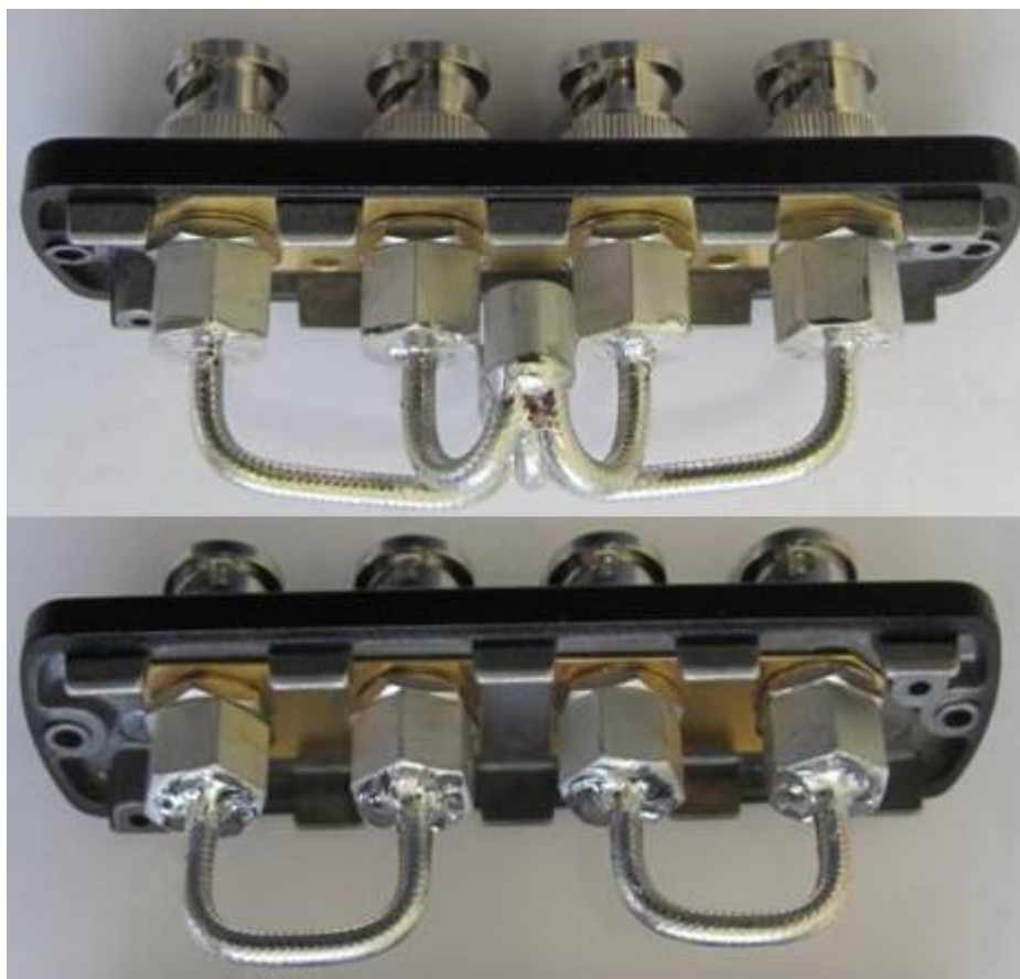
Рисунок 4.2 - Мера нуля сопротивления и мера нуля проводимости со снятым корпусом. Внешний вид
