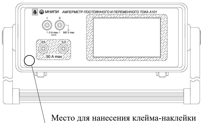
Рисунок 1.2 – Передняя панель амперметра А101. Место нанесения клейма-наклейки
