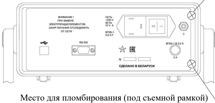
Рисунок 1.3 – Задняя панель амперметра А101. Места нанесения оттиска и пломбирования
