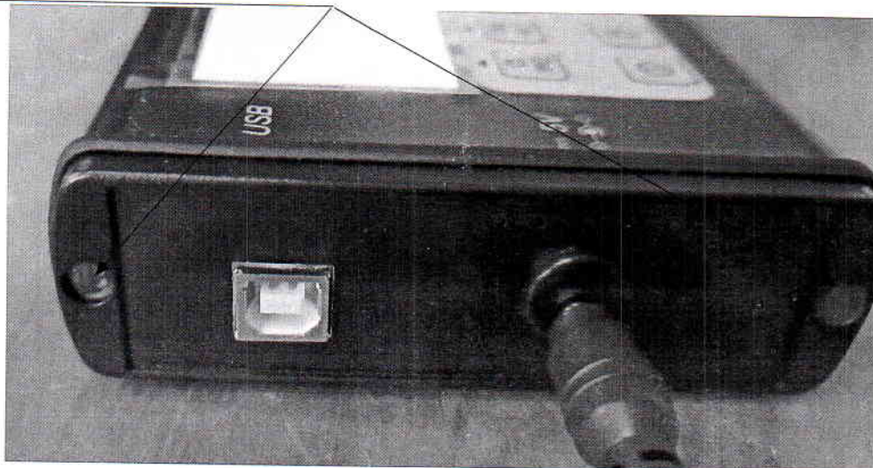
Рисунок 3.1 – Схема пломбировки от несанкционированного доступа
