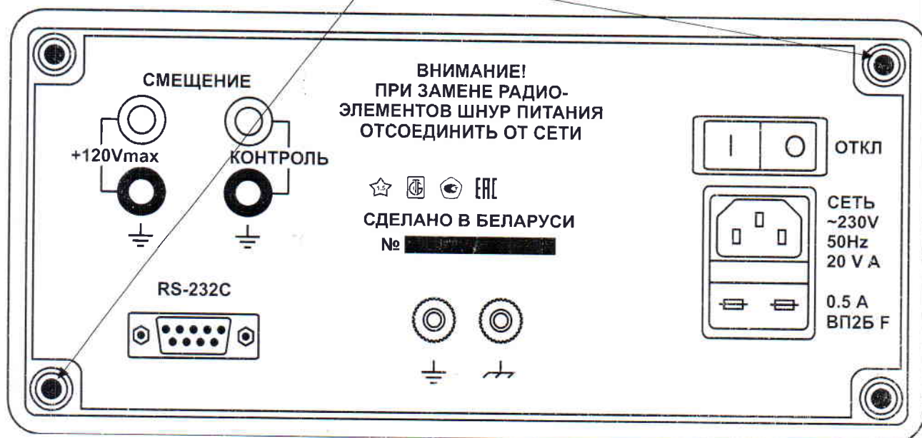
Рисунок 3.1 – Схема пломбировки от несанкционированного доступа
